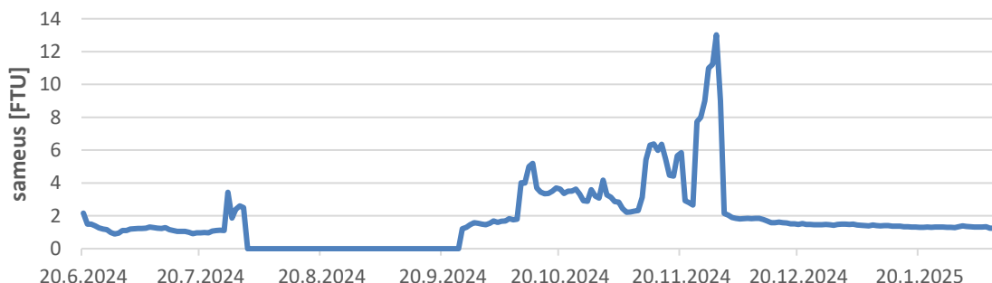
Kuva 34. Kuvassa jatkuvatoimisen EXO-mittausanturin sameuden arvoja Kiesilänjoelta 20.6.2024 - 9.2.2025.
