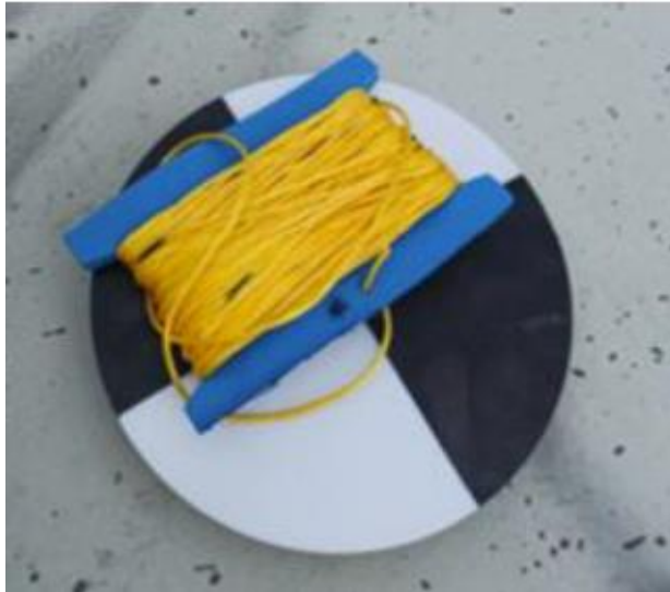
Kuva 23. Näkösyvyysmittaukset suoritetaan Secchi-levyllä ja narulla.
