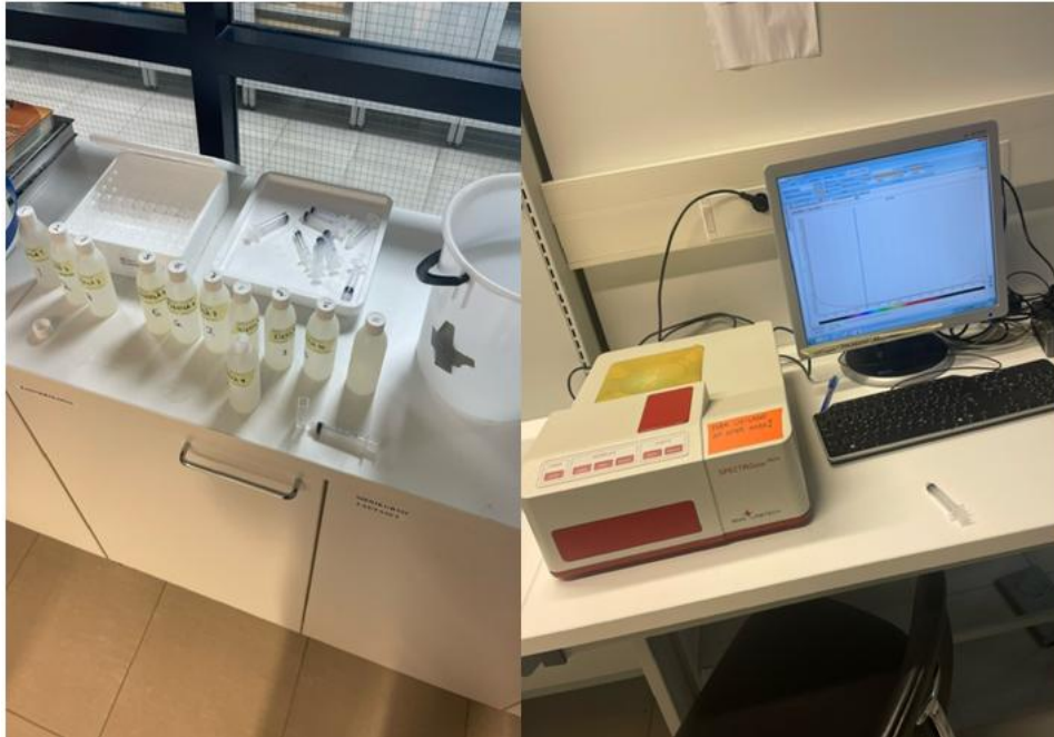
Kuva 22. Näytteet siirrettiin ruiskulla näytepulloista kyvetteihin ja mittauksessa käytettiin kuvassa oikealla näkyvää SPECTROstarNANO -mittalaitetta.
