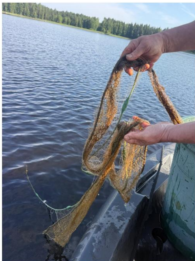
Kuva 15. Pyyntiruudun 5 pohjaverkko 4 metrin syvyydessä limoittui pahasti yhden yön aikana.
