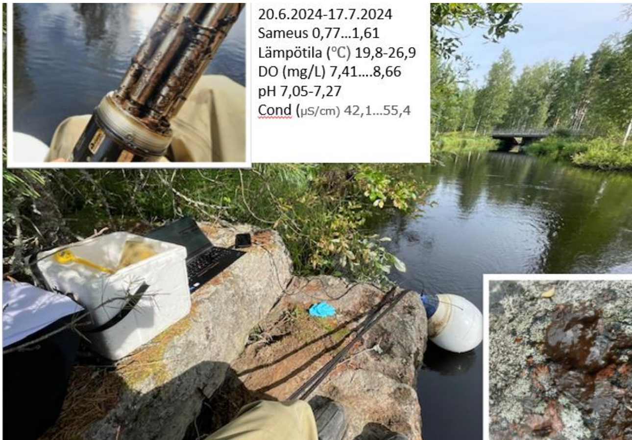
Kuva 4. Jatkuvat toimista mittaria tuli välillä putsata siihen kertyneestä liasta, samalla kun mittaustuloksia siirrettiin tietokoneelle. Kertynyttä ainesta tarkasteltiin laboratoriossa mikroskoopilla ja sen todettiin olevan todennäköisesti valuma-alueelta irronnutta maa-ainesta. Näytteessä ei näkynyt leviä.
