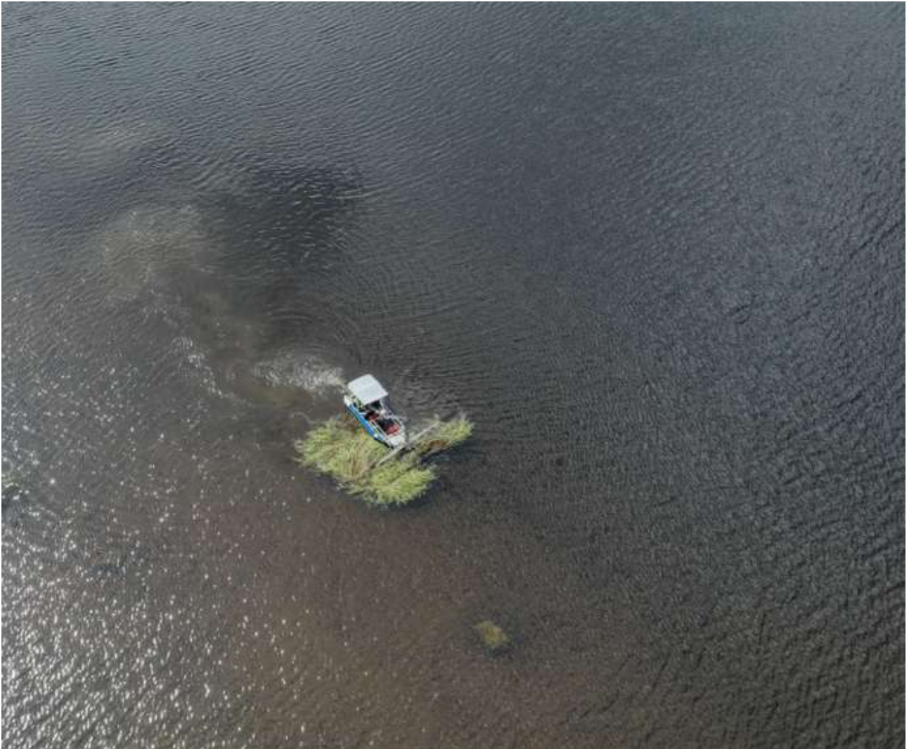
Kuva 6. Niittomateriaalia työnnettiin rantaan veneeseen kiinnitetyn niittopään avulla.
